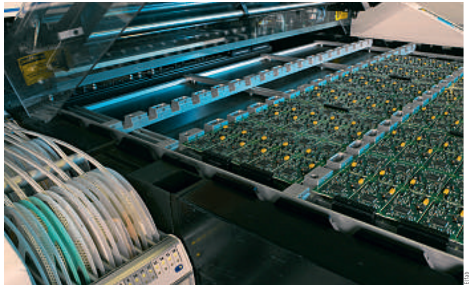
Die elfab AG verfügt über einen Bestückungsautomaten mit einer Bestückungsfläche von 550 mal 1100 mm für grossflächige LED-Baugruppen
