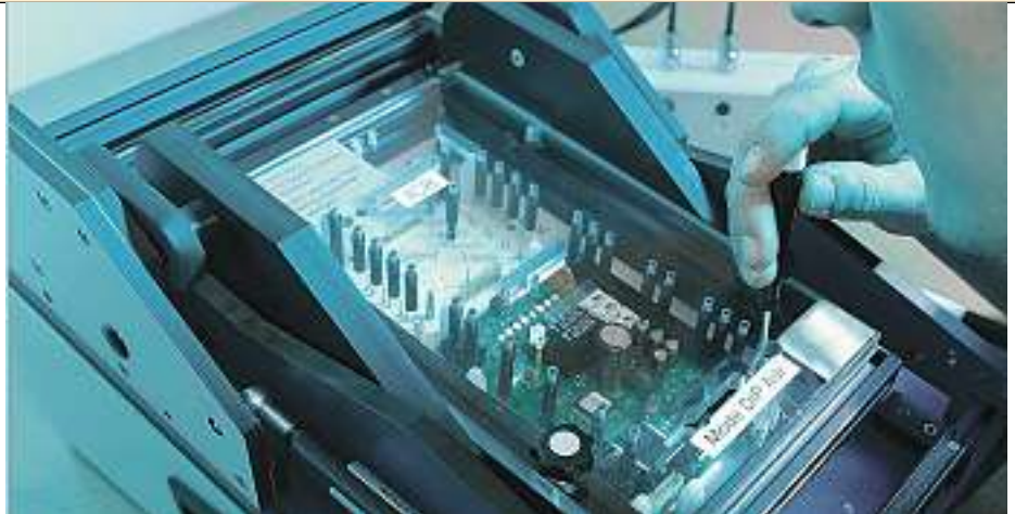
Die Steuerelektroniken, z.B. für Zugangskontrollsysteme oder Züge der SBB, werden nach Kundenvorgaben funktionsgeprüft
