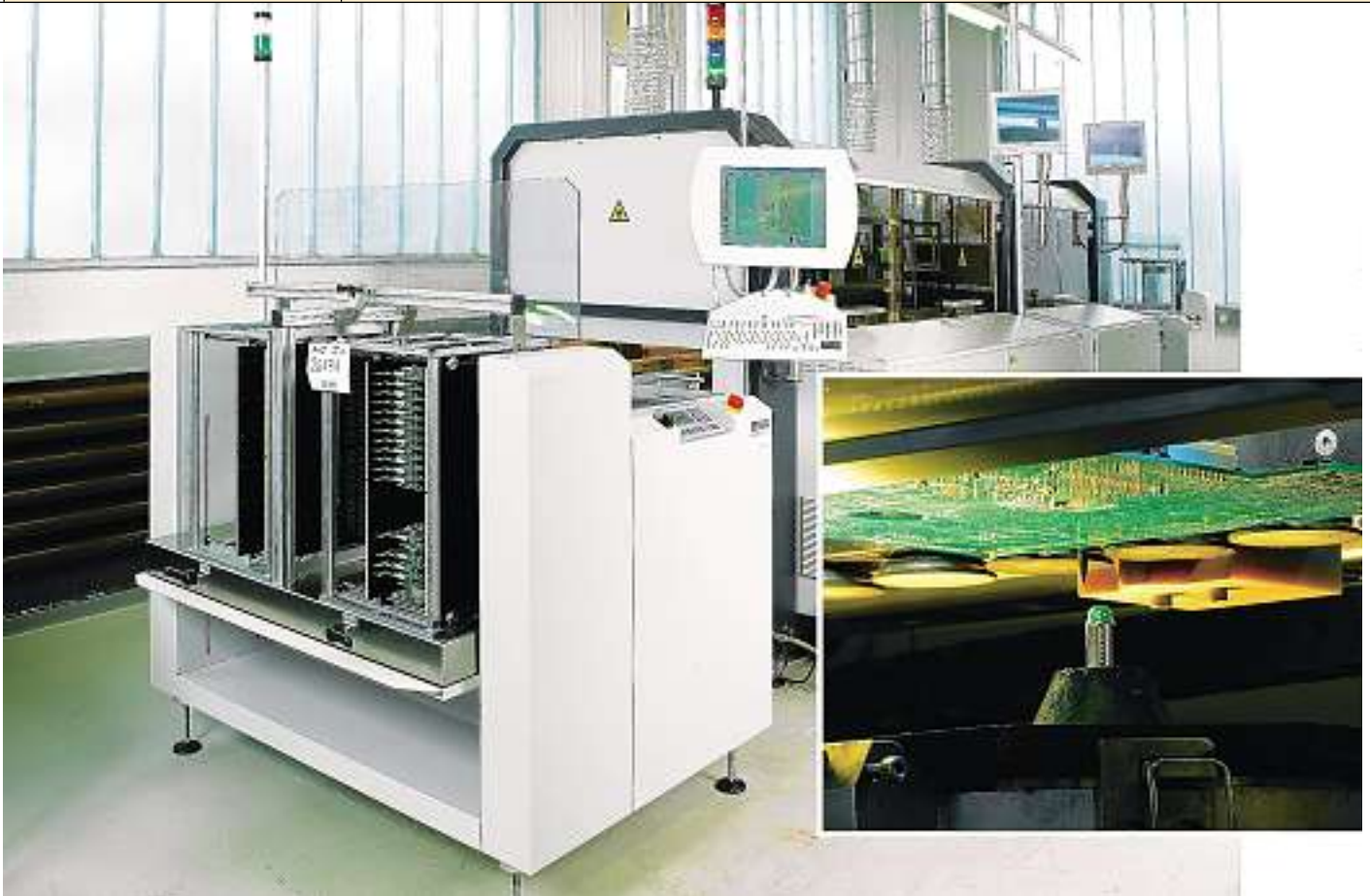
Reproduzierbare hohe Lötqualität auch bei komplexen Schaltungen wird mit der neuen Selektivlötanlage erreicht
