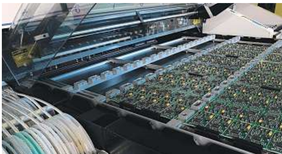
Bis zu 15 000 Bauteile pro Stunde können an einzelnen Automaten auf Platinen bis zur Grösse von 1100 × 850 mm bestückt werden
