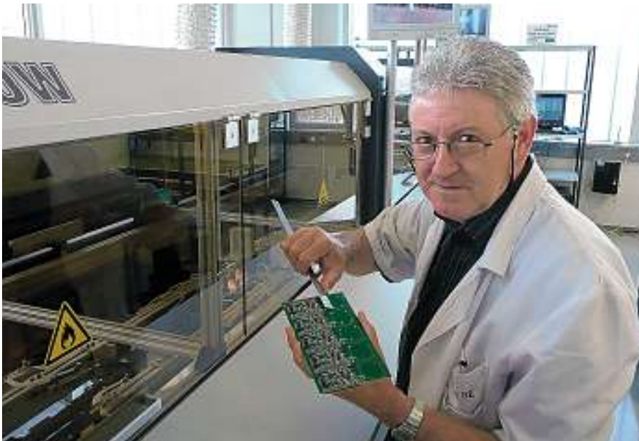
Heinz Jäggi beim Optimieren der Lötprogramme «seiner» Selektiv-Lötanlage – 70 Prozent der bisherigen Handlötarbeiten lassen sich auf die Lötanlage transferieren
