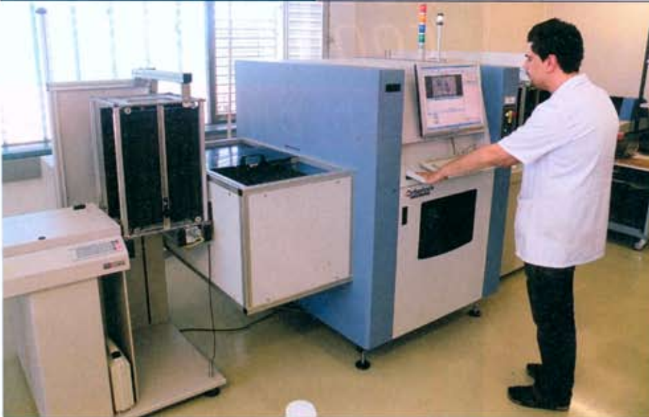
AOI-Spezialist Christian Andreoli verfolgt die Fehlermeldungen systematisch und gibt zeitnahes Feedback zur Prozessverbesserung an die Produktion
