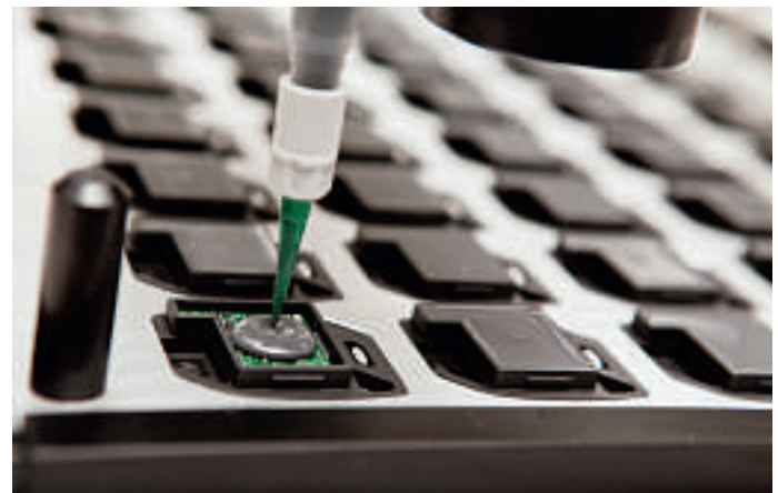
Beim Einspritzen vermischen sich die Komponenten und der Verguss verteilt sich auf der Leiterplatte in der Gehäuseform
