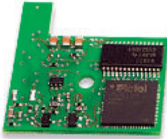
Schlüsselelektronik ungeschützt, zur Demonstration nach Verguss wieder halb geöffnet und in der Gehäusefassung vergossen
