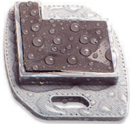
Schlüsselelektronik ungeschützt, zur Demonstration nach Verguss wieder halb geöffnet und in der Gehäusefassung vergossen
