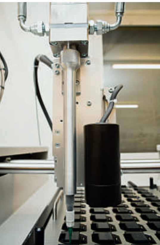
Beim 2K-Silikonvergiessprozess, wie hier beim Autoschlüssel, gelangen beide Komponenten von oben separat in den Dosierkopf
