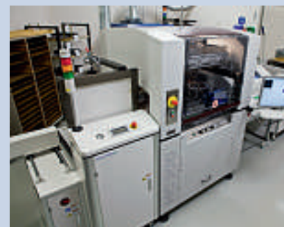
Kompaktanlage zum automatisierten Lackieren und Vergiessen
