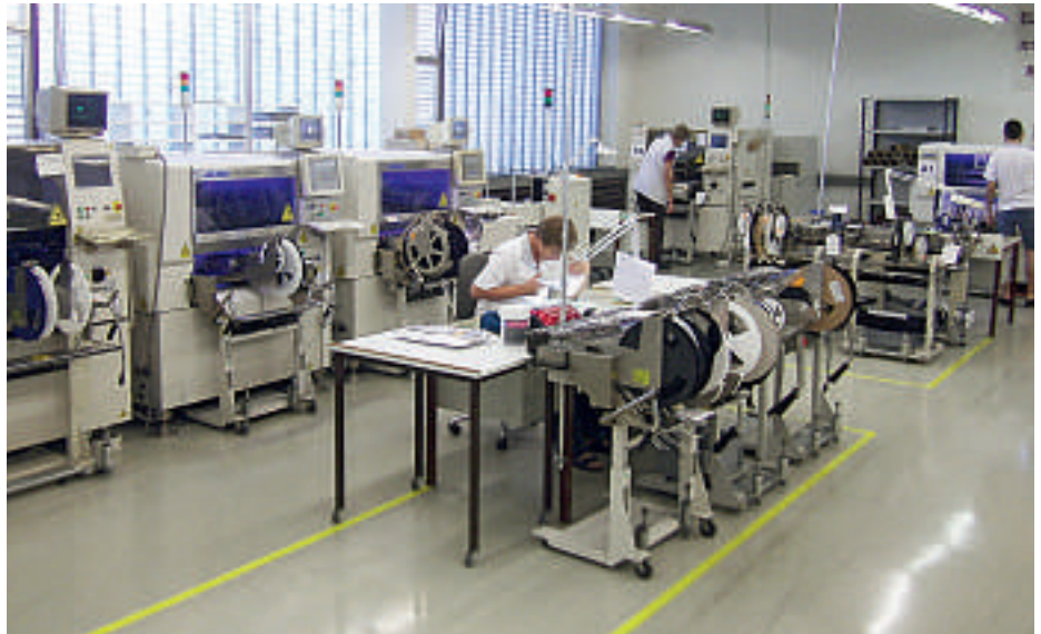
Ausschnitt aus der Inselfertigung – 3 von 5 individuellen Juki-Bestückungssystemen. Für komplexe Prints nutzt elfab eine Juki-Kombi aus 3 Automaten mit insgesamt 240 Feederplätzen
